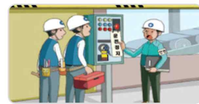
기동장치, 잠금조치, 표지판 설치
